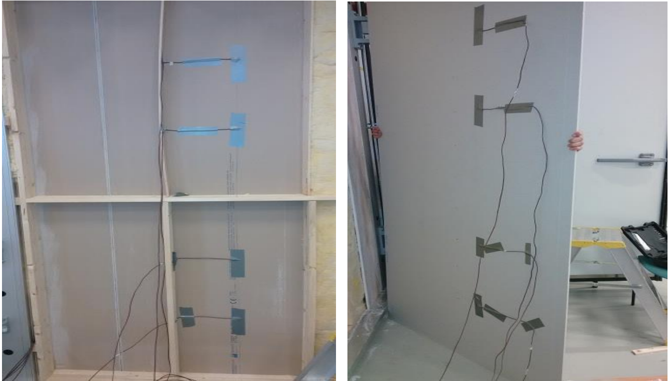
Figur 56. Eksperimentet, plassering av sensorene på innvendig overflate av veggen. Bildet tatt av M Anwar
