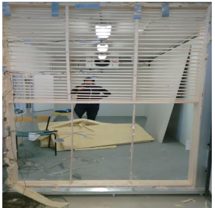
Figur 54. Veggens ramme er blitt montert på plass for eksperimentet, bildet er tatt av M Anwar
