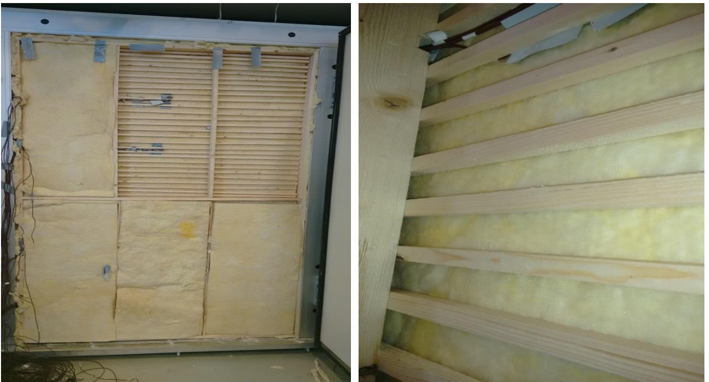
Figur 59. Eksperiment, Isolering prosessen av veggen. Bildet er tatt av M Anwar
