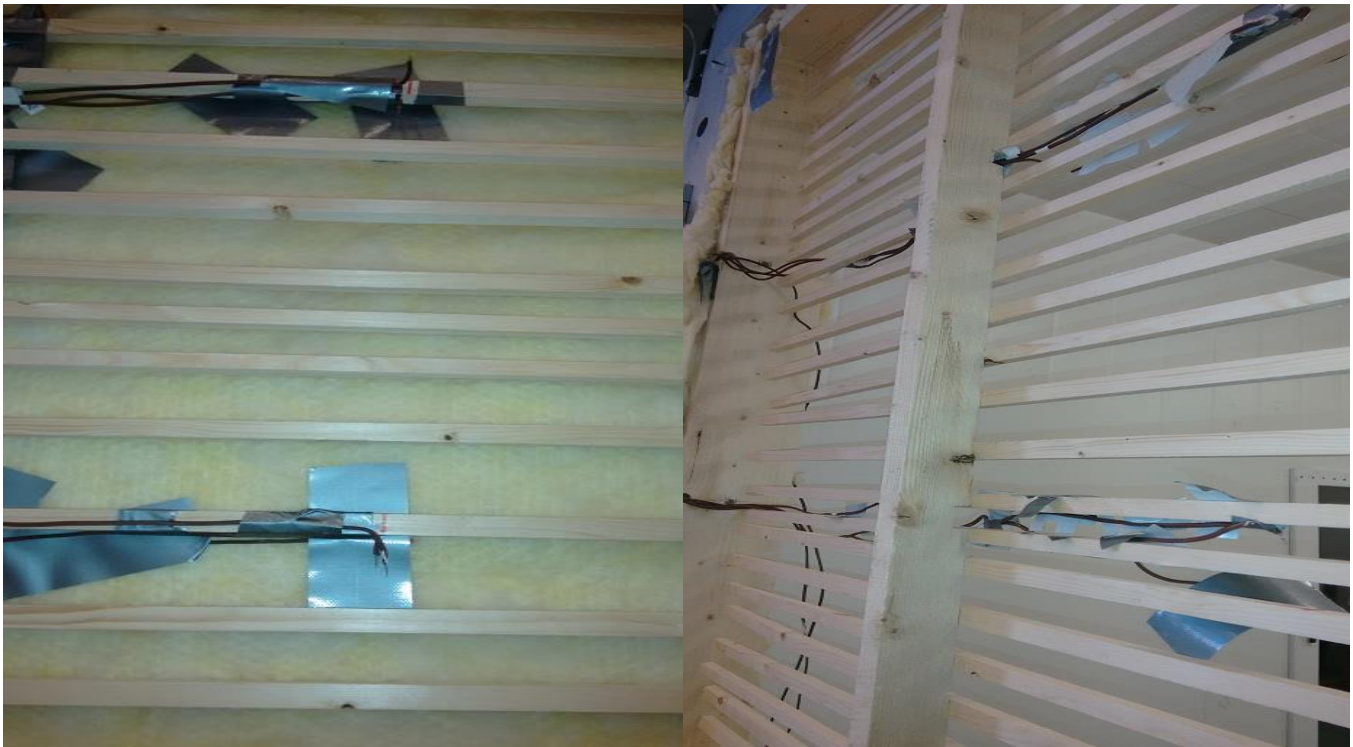
Figur 57. Eksperiment, Montering av sensorene i luftlags området. Bildet er tatt av M Anwar
