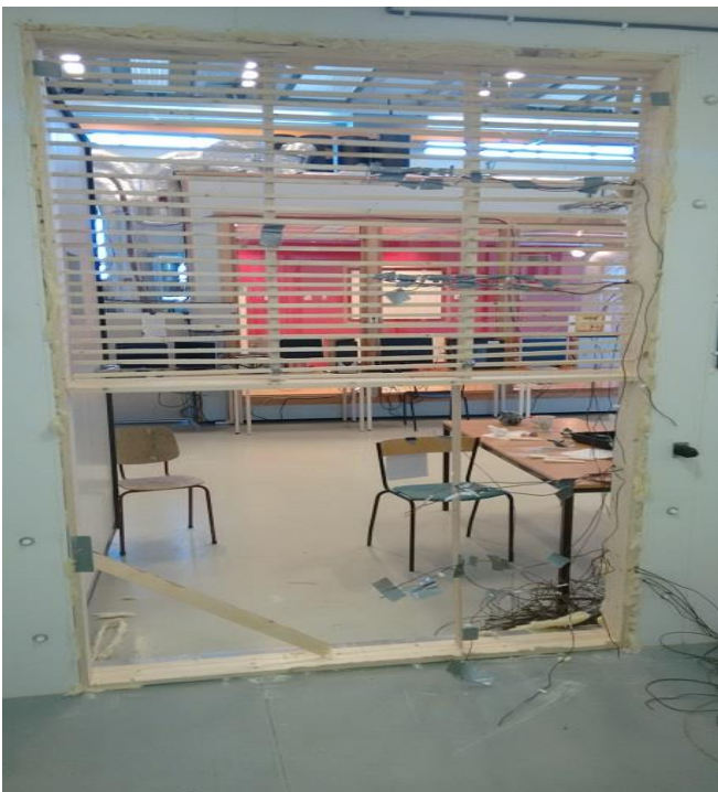
Figur 54. Veggens ramme er blitt montert på plass for eksperimentet, bildet er tatt av M Anwar
