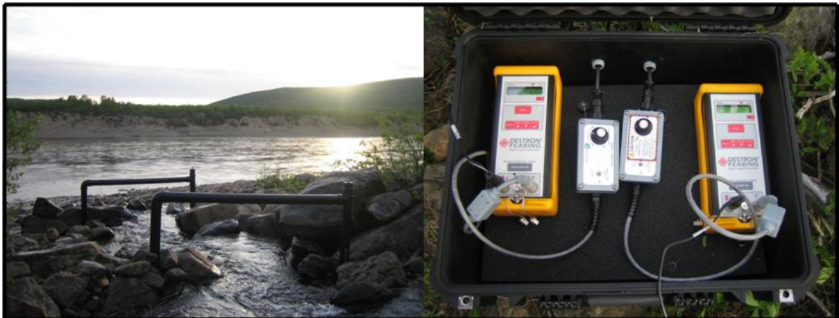
Figur 4: Bildet til venstre viser to stasjonære antenner i Vidgaveadji som overvåker utvandring av PIT-merkede lakseyngel. Bildet til høyre viser to loggere koblet opp til antennene (foto: Kjell-Magne Johnsen).
