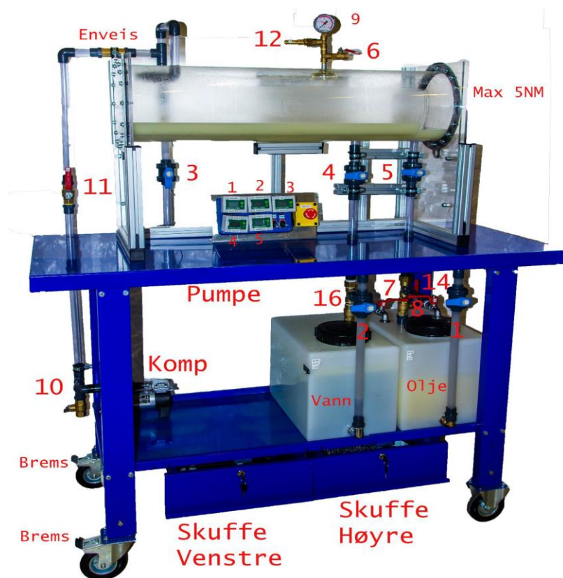
Figure 19 three-phase separator from UIT
