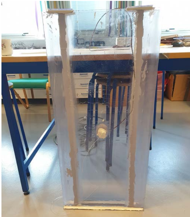
Figur 3.2 Vannmodul inne i TIVT veggen. Fest sammen med lim som Tek7.
