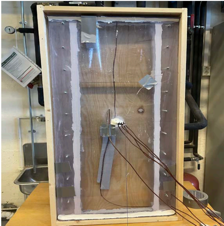
Figur 3.4 Vannmodulen fylt med vann og TIT montert i tre-ramme.
