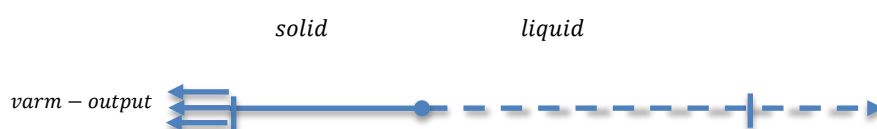
Figur 2.7 For frysning prosess: Melting front X(t) , etter en tidsperiode \Delta t , PCM-tykkelsen x \in [0, l] .
