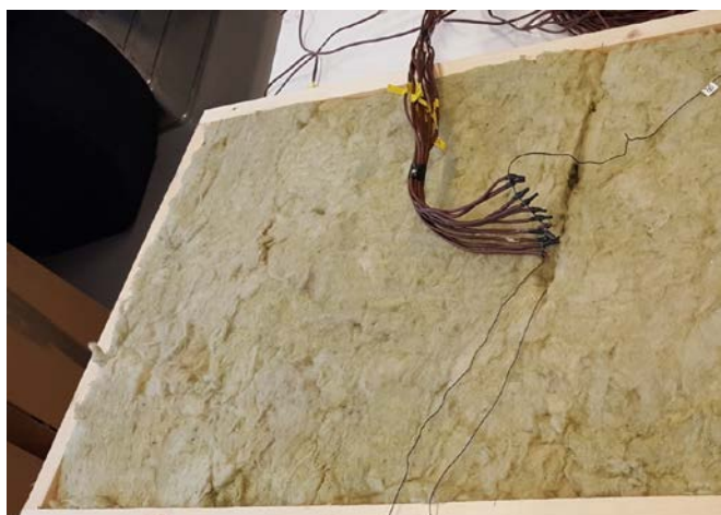
Figur 3.1 Det plasseres 13stk termometer i forskjellige posisjoner i TiT-veggen.
