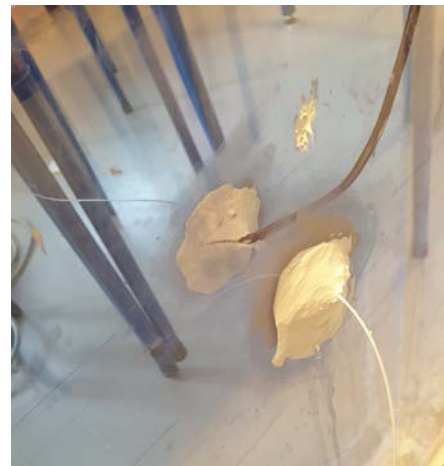
Figur 3.3 Termometer som plassering midt i vegg-modulen. Hange på fisksnører.
