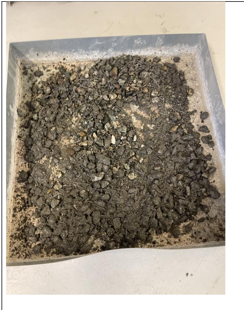
Figur 28: Brukt magnet for å samle fiber fra fersk betong
