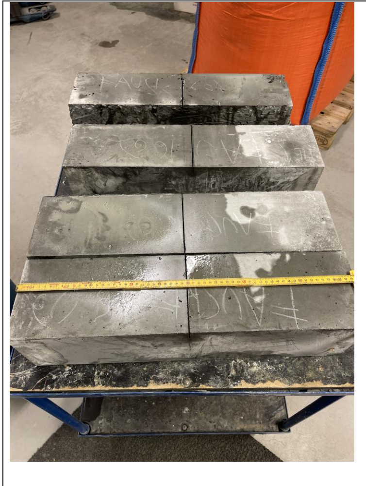
Figur 26: Kutt i bjelke for å kunne gjøre C_{mod}
